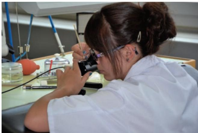
*Dans une classe horlogère, une apprentie mesure la marche d'une montre mécanique simple et ajuste son mouvement en se servant d'une cheville de bois.*
