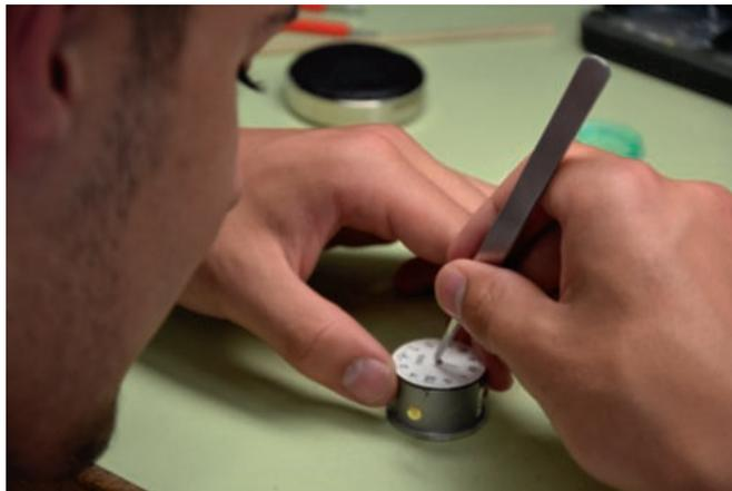
*Dans l'atelier d'une école d'horlogerie, un apprenti effectue, à l'aide de brucelles, le posage des aiguilles sur un mouvement de montre muni de son cadran.*
