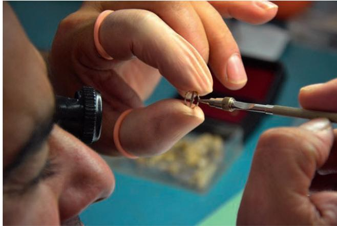
*Dans l'atelier d'une petite entreprise indépendante, un horloger procède à l'équilibrage dynamique d'un balancier lors du réglage d'un mouvement mécanique.*
