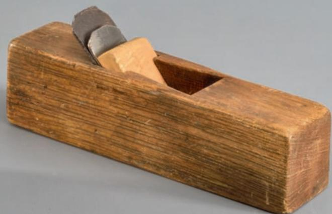
Outil de menuiserie, de petite dimension à semelle plate, consistant en un ciseau ajusté obliquement dans un support de bois utilisé pour aplanir, amincir, supprimer les inégalités de surface d'une pièce de bois ou pour y faire des moulures, des rainures.
